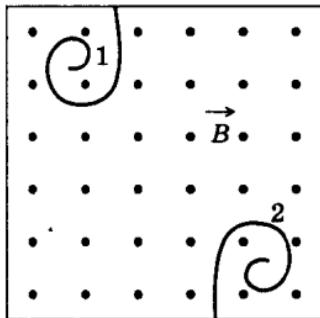
2. /5.3.1/ В камере Вильсона, помещенной во внешнее магнитное поле таким образом, что вектор индукции магнитного поля направлен перпендикулярно плоскости рисунка на нас, были сфотографированы треки двух частиц. Какие из треков могут принадлежать электрону?
