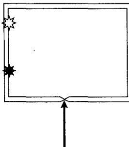
/5.3.1/ В камере прибора создано магнитное поле (см. рисунок), направленное перпендикулярно плоскости рисунка от нас. В прибор влетают с одинаковыми скоростями разные частицы, являющиеся продуктами различных ядерных реакций (электроны  ${}_{-1}^0e$ , позитроны  ${}_{+1}^0e$ , протоны  ${}_1^1p$ , нейтроны  ${}_0^1n$ ,  $\alpha$ -частицы  ${}_2^4He$  и  $\gamma$ -кванты). На экране попаданию в него позитрона соответствует вспышка
