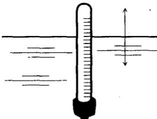
7. Ареометр, погруженный в жидкость, совершает малые вертикальные гармонические колебания с частотой 0,2 Гц (см. рисунок). Площадь сечения трубки ареометра  $10 \text{ мм}^2$ , его масса 50 г. Пренебрегая сопротивлением жидкости, найдите ее плотность.
